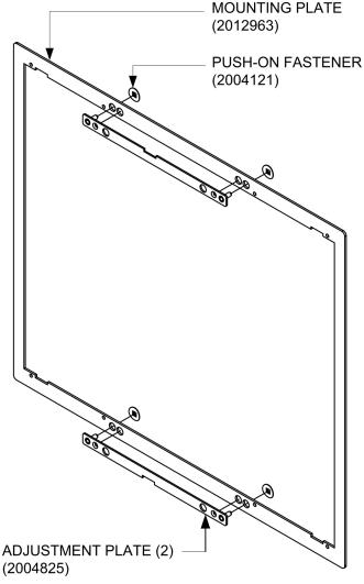
NOTE: DO NOT PUSH THE PUSH-ON FASTENERS ALL THE WAY DOWN ONTO THE PINS.
