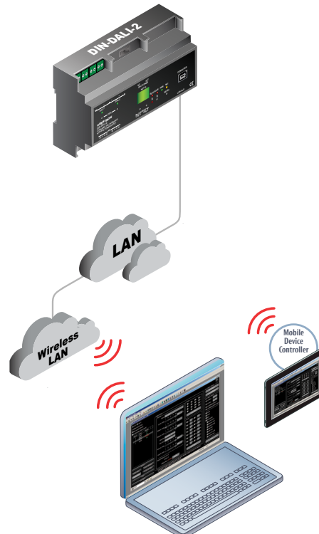
DIN-DALI-2 Over a LAN and Wireless LAN
